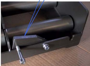
Sicherung gegen das Abrollen der Batterie
